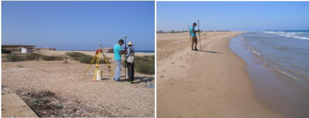
Photos 1 et 2. Stations fixe (1) et mobile (2) et mesure RTK (8 octobre 2017)
