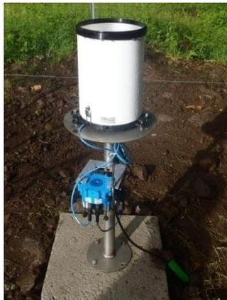
**Figure 1. Pluviomètre Automatique**
