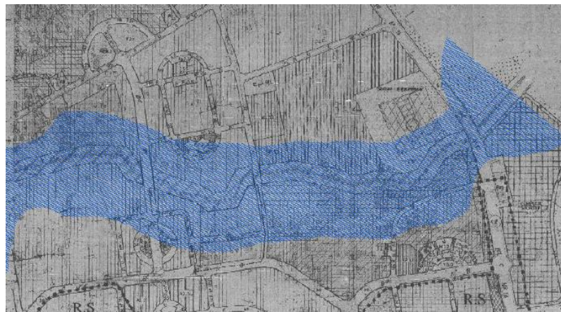
Fig.2 : Zone inondable sous-estimée durant l'élaboration du plan d'aménagement de 2000 au niveau de Nador
