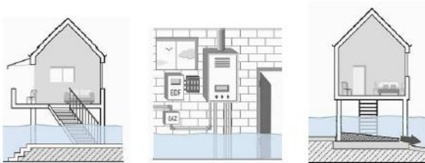
Doc 7. Les modes de construction en zone inondable. La règle du « duplex » permet de construire en zone inondable mais d'habiter au-dessus de la ligne des plus hautes eaux connues. (in site Internet Val-de-Marne.developpement-durable.gov.fr)
